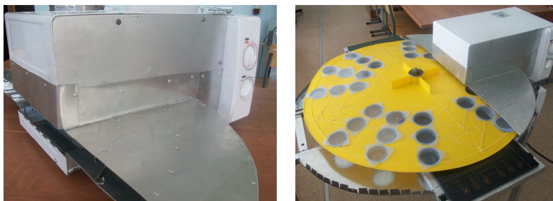
Рис. 3. Реальное исполнение запердельного волновода и резонаторных камер с запердельными диафрагмированными волноводами, обеспечивающими транспортирование творожного сыря в контейнерах, размещенных в ячейках диэлектрического конвейера
