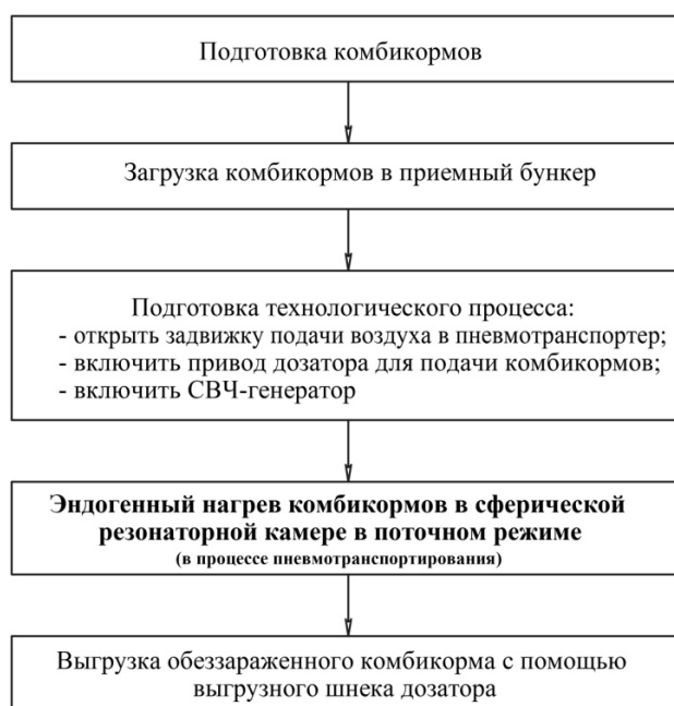
Рис. 1. Операционно-технологическая схема процесса обеззараживания комбикормов воздействием ЭМП СВЧ
