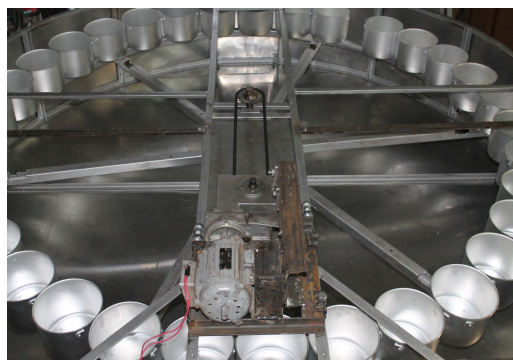
Рис. 2. Расположение нижних частей резонаторных камер на роторе установки для термообработки крови убойных животных
