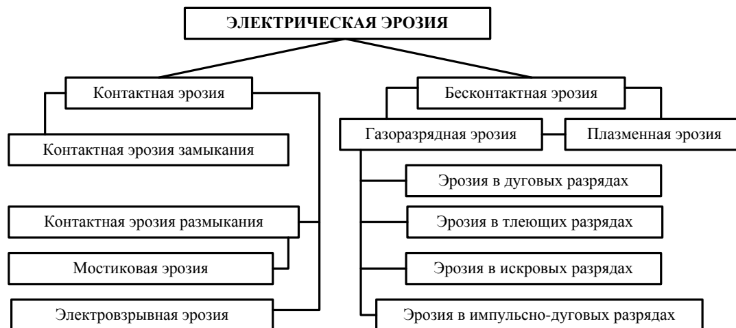
Рис. 1. Классификационная схема электрической эрозии
