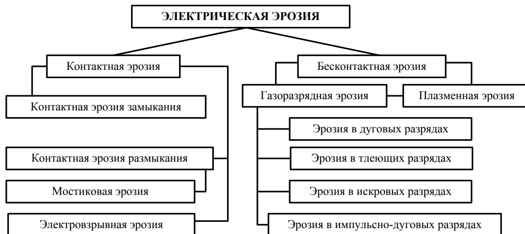
Рис. 1. Классификационная схема электрической эрозии
