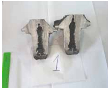
Рис. 7. Прибыли (в разрезе) на отливке «Корпус буксы» после опробования теплоизоляционных оболочек
